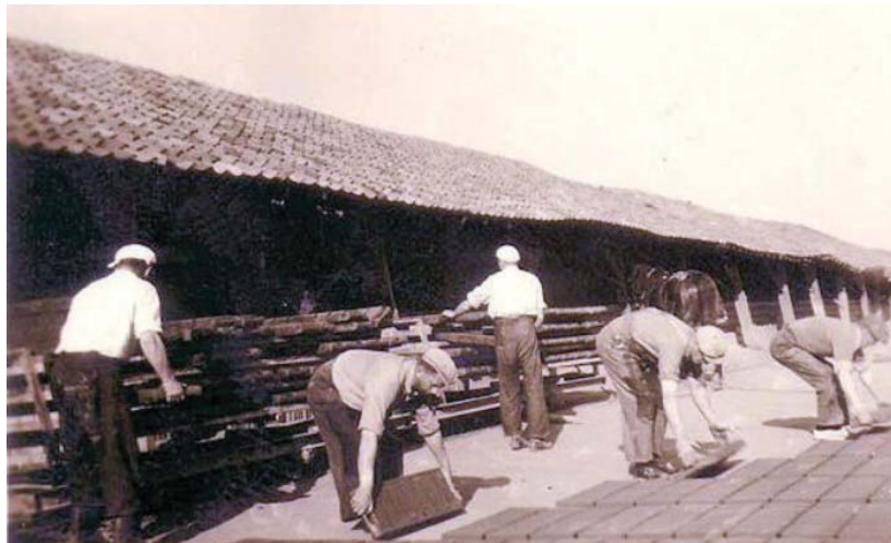
Op de steenoven is heel wat afgezwoegd. Hier worden natte stenen uit de handvorm uitgelegd. Op de achtergrond een haaghut waar stenen worden gedroogd voor ze de oven in gaan. Bron: http://www.oudbeuningen.nl/steenoven/staartjeswaard
